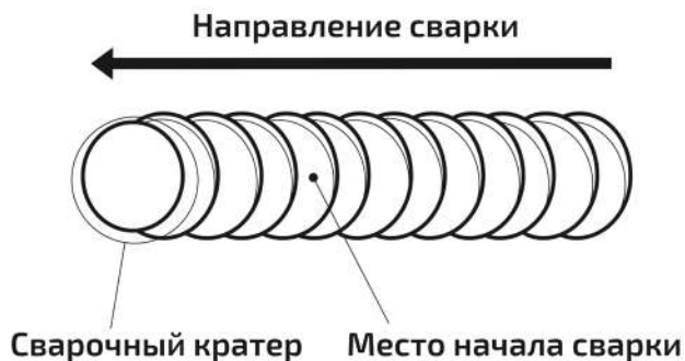
Рис. 8.1.2. Начало сварки при смене электрода.
