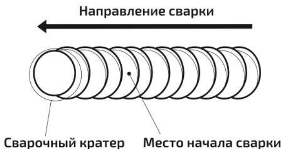
Рис. 11.1.2. Начало сварки при смене электрода.
