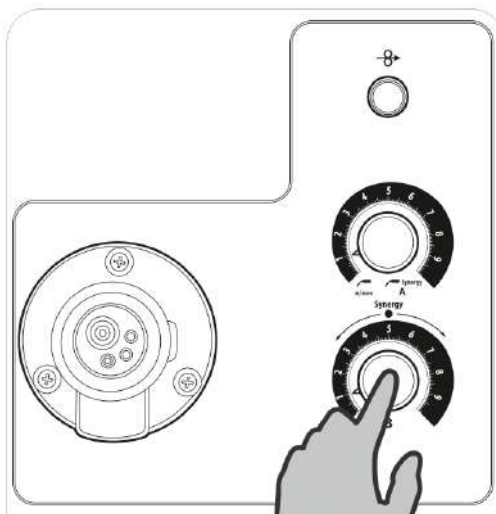
Рис. 8.6.2. Установка напряжения на дуге.
