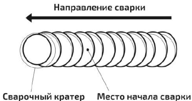
Рис. 12.1.2. Начало сварки при смене электрода.
