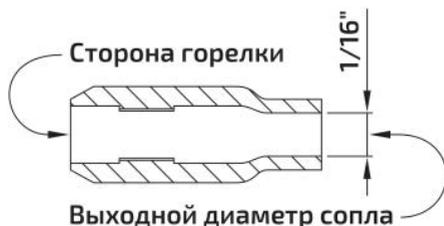
\* Если не указан выходной диаметр, то его можно определить по номеру сопла.
