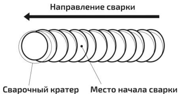
Рис. 12.4. Начало сварки при смене электрода.
