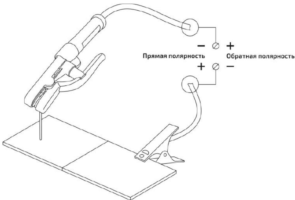
Рис. 10.2.1. Способы подключения.
