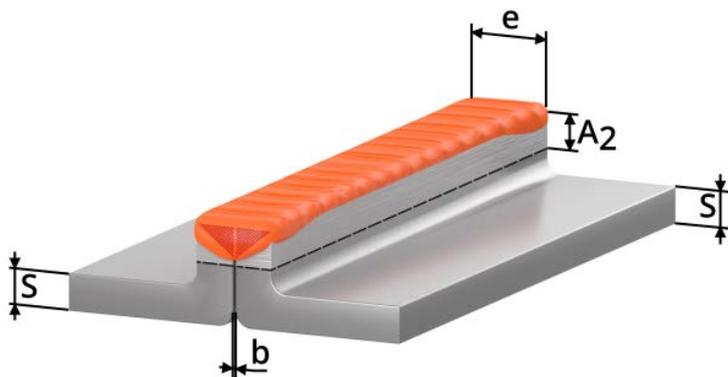
Рис. 13.0.4. Пример соединения с отбортовкой.
