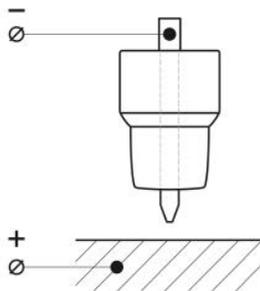
Рис. 12.1.1. Полярность при TIG сварке.
