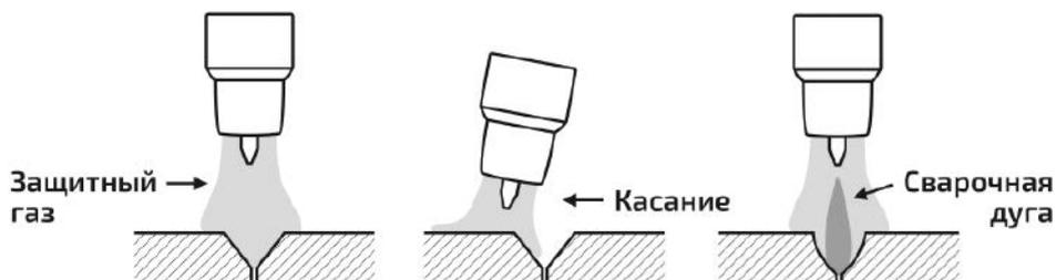
Рис. 12.1.2. Процесс образования сварочной дуги.
