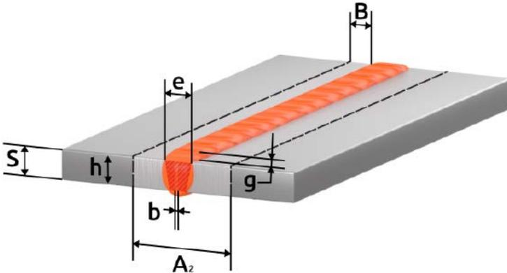
Рис. 13.0.1. Пример стыкового соединения.
