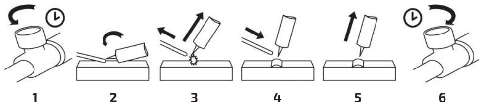
Рис. 12.7.3. Способ поджига дуги от присадочного прутка.
