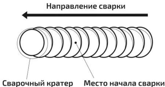
Рис. 10.1.2. Начало сварки при смене электрода.
