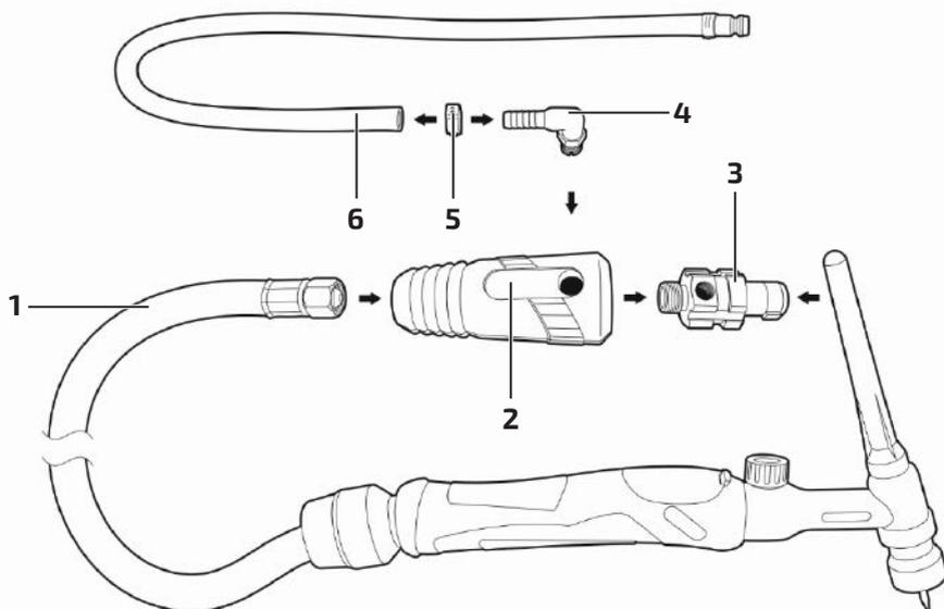
Рис. 12.3.1. Схема сборки ОКС 35–50.
