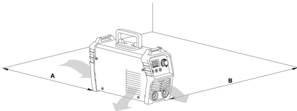
Рис. 8.2.1. Установка оборудования от стен.
