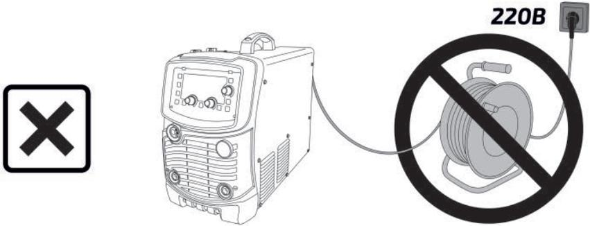
Рис. 9.0.4. Схема неправильного подключения и удлинения кабелей сварочного аппарата.
