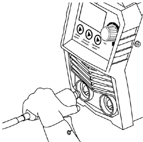
Рис. 9.0.5. Подключение сварочных кабелей.
