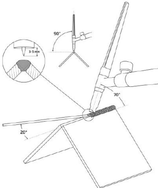
Рис. 12.9.4. Угловое внешнее соединение.
