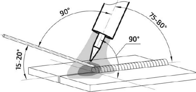
Рис. 12.8.1. Угол наклона горелки.
