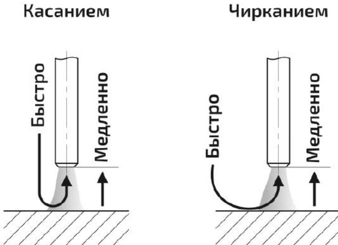
Рис. 10.0.1. Способы зажигания сварочной дуги.
