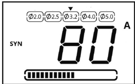
Рис. 9.1.4. Диаметр электрода выбран.
