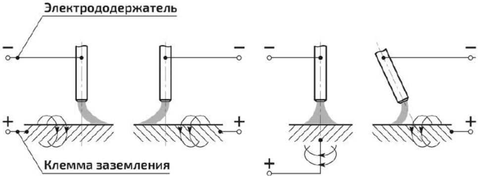
Рис. 10.3.1. Схема отклонения дуги постоянного тока.
