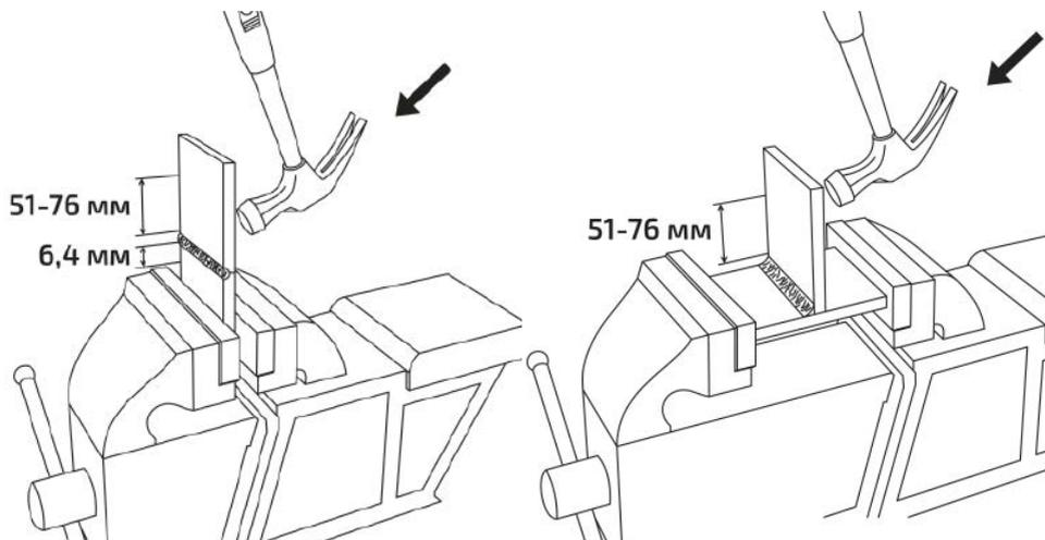
Рис. 15.1.1. Проверка на прочность сварного соединения.
