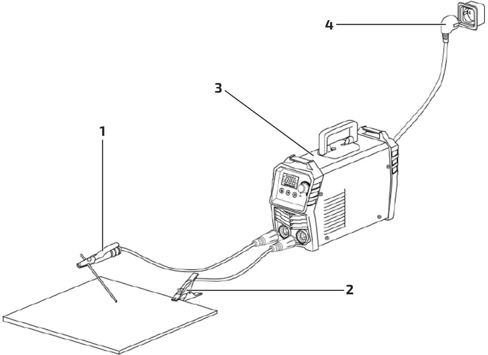
Рис. 9.0.1. Схема подключения оборудования.
