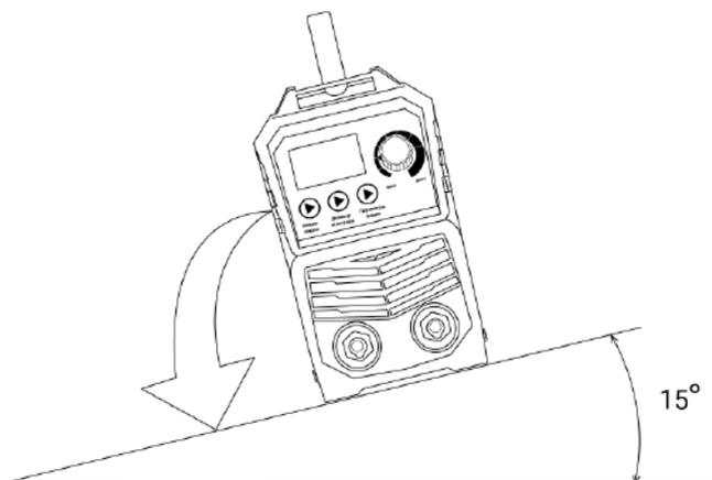
Рис. 8.3.1. Установка оборудования на поверхности.
