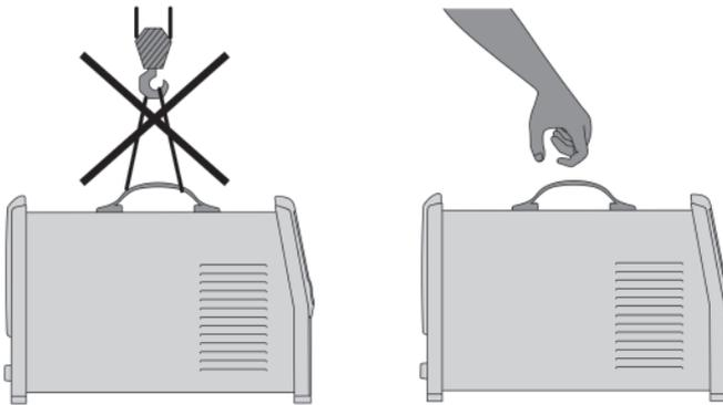
Рис. 8.1.1. Переноска сварочного аппарата.
