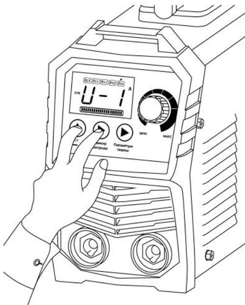
Аппарат позволяет включать/выключать данную функцию. По умолчанию VRD выключен. Для включения/выключения необходимо нажать и держать кнопки выбора режима сварки и диаметра электрода в течение 3-х секунд (см. рис. 7.0.7).
