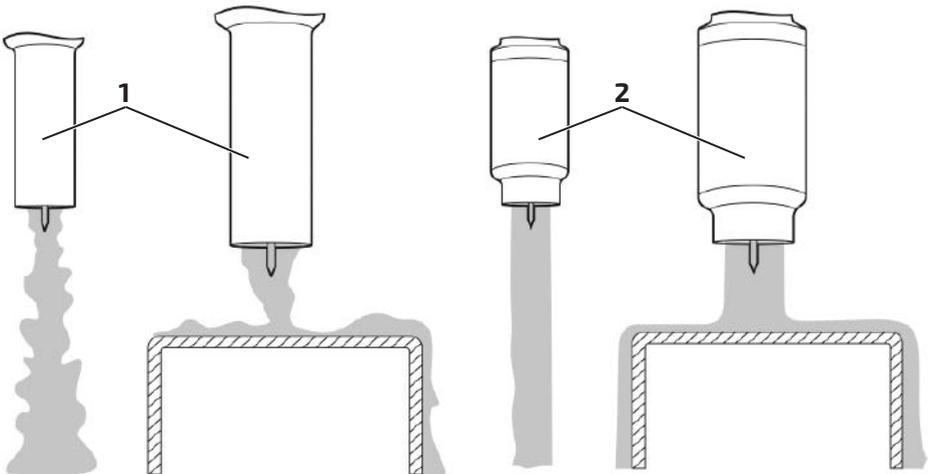
Рис. 12.6.1. Различие газового потока: обычное сопло и газовая линза.
