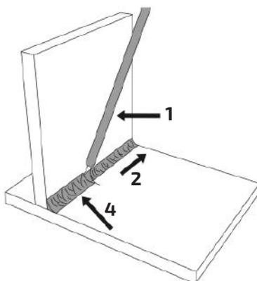
Рис. 10.5.1. Угол наклона покрытого электрода.
