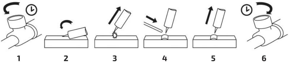
Рис. 12.7.2. Способ поджига дуги от сопла горелки.
