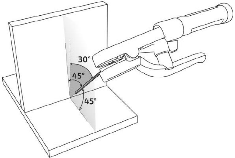
Рис. 10.1.3. Угол наклона электрода.
