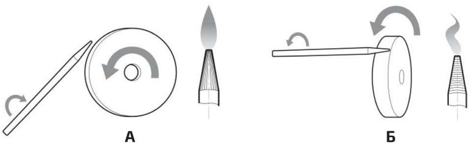
Рис. 12.5.2. Пример заточки вольфрамового электрода.
