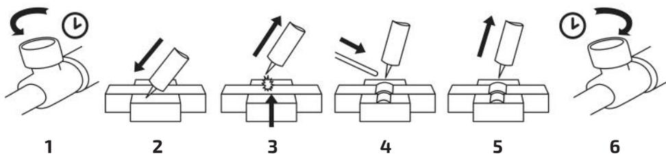
Рис. 12.7.4. Способ поджига дуги на выводной пластине.
