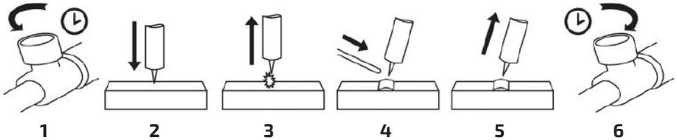
Рис. 12.7.1. Способ поджига дуги касанием.
