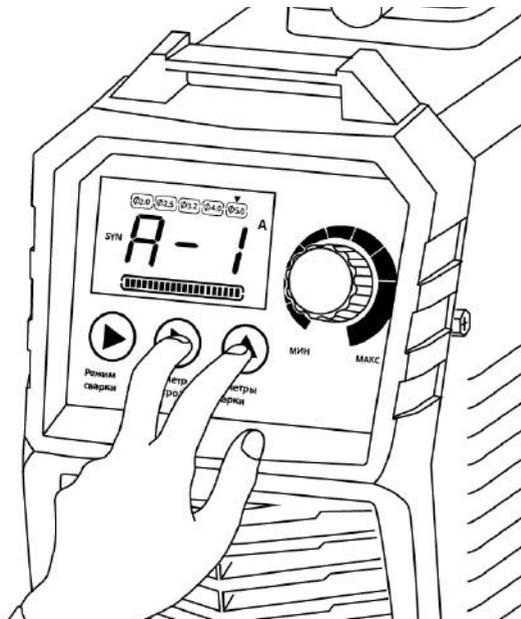
Аппарат позволяет включать/выключать данную функцию. По умолчанию Antistick включен (см. рис. 7.0.6). Для включения/выключения необходимо нажать и держать кнопки выбора диаметра электрода и параметров сварки в течение 3-х секунд.
