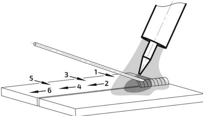
Рис. 12.8.2. Пример манипуляции присадочной проволокой при TIG сварке.
