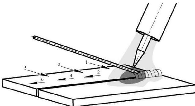
Рис. 12.14. Пример манипуляции присадочной проволокой при TIG сварке.
