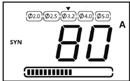
Рис. 9.9. Диаметр электрода выбран.
