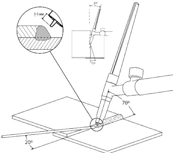
Рис. 12.16. Нахлесточное соединение.
