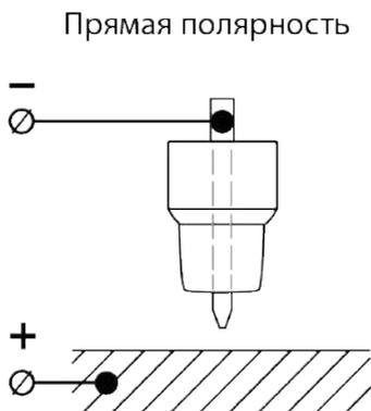
Рис. 12.1. Полярность при TIG сварке.
