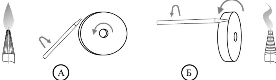
Рис. 12.5. Пример заточки вольфрамового электрода.
