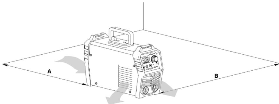
Рис. 8.3. Установка оборудования от стен.
