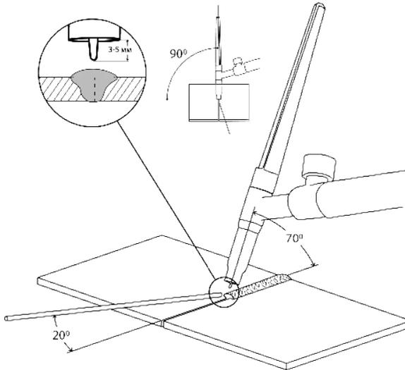
Рис. 12.15. Стыковое соединение.
