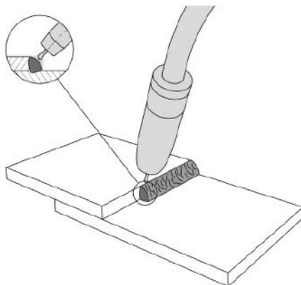
Слишком большой угол наклона горелки.
