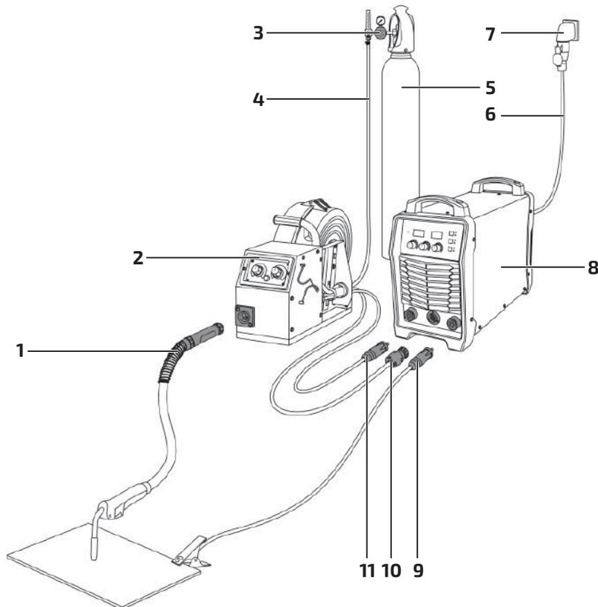
Рис. 8.0.1. Схема подключения оборудования при сварке сплошной проволокой.
