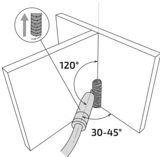
Угол наклона горелки при сварке тонколистового металла.
