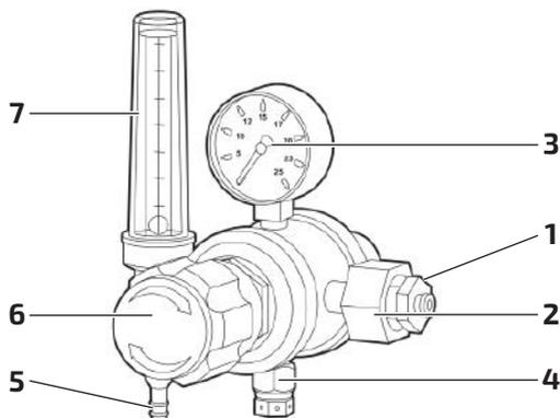
Рис. 9.10.1. Двухступенчатый регулятор расхода газа с ротаметром.
