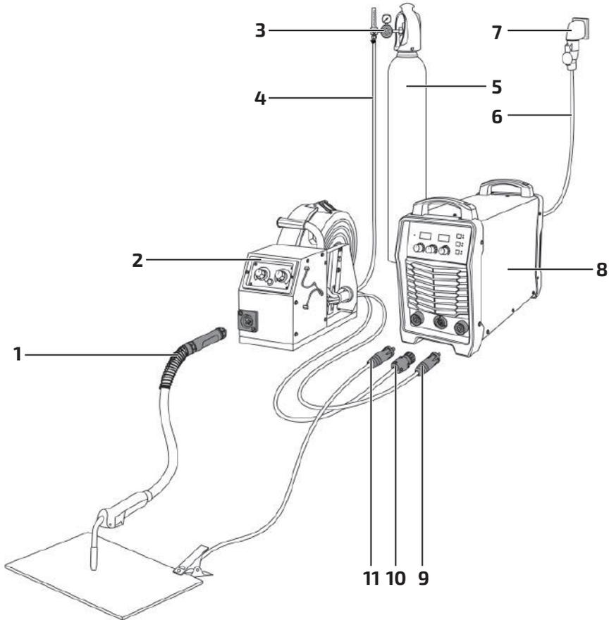
Рис. 8.0.2. Схема подключения оборудования при сварке порошковой проволокой.
