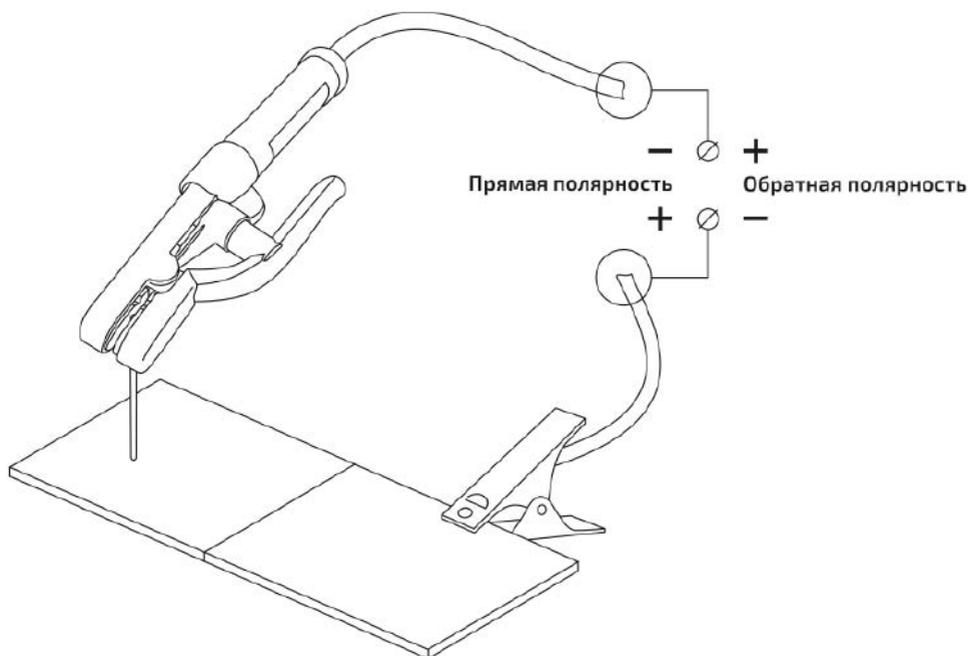
Рис. 11.2.1. Способы подключения.
