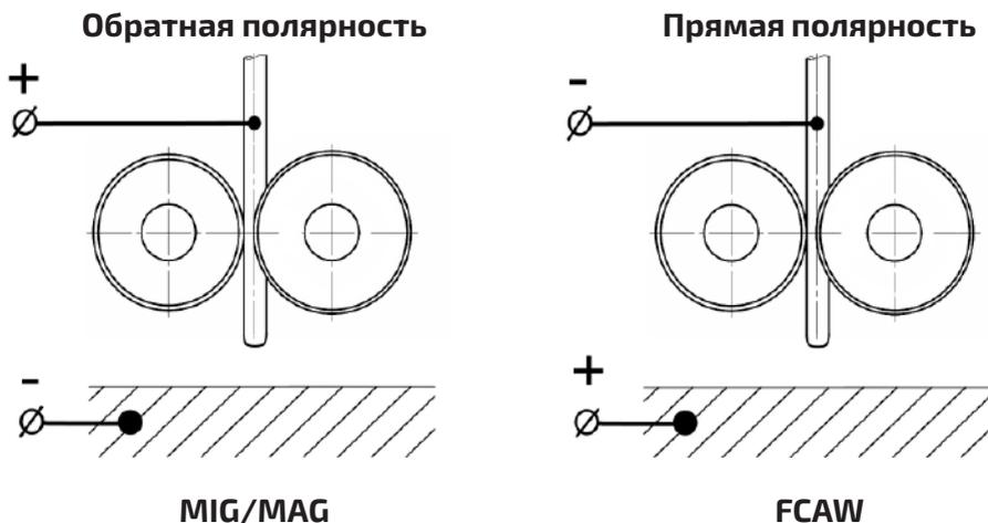
Рис. 9.1.1. Выбор полярности при MIG/MAG и FCAW сварки.
