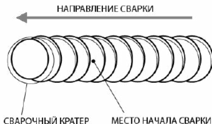
Рис. 11.2.2. Начало сварки при смене электрода.
