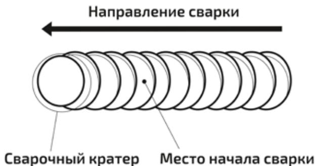
Рис. 8.1.2. Начало сварки при смене электрода.
