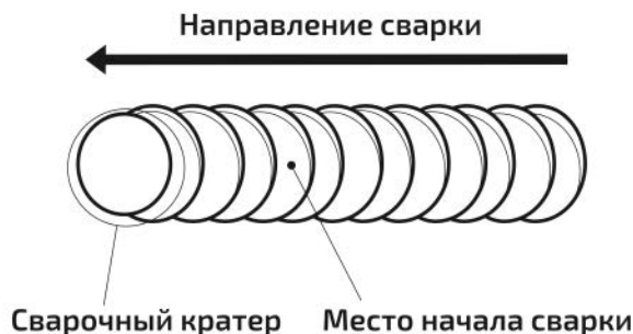
Рис. 9.1.2. Начало сварки при смене электрода.
