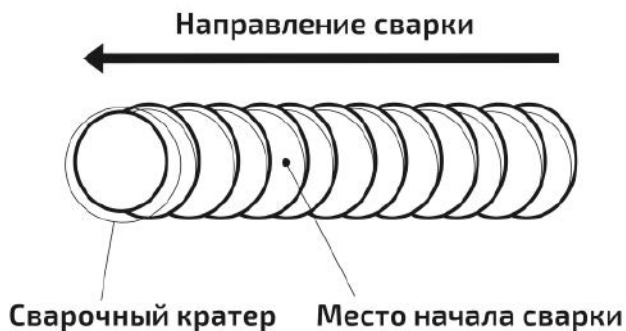
Рис. 8.1.2. Начало сварки при смене электрода.
