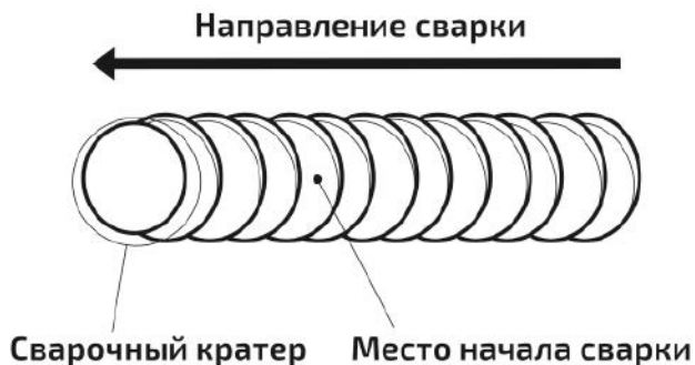
Рис. 8.1.2. Начало сварки при смене электрода.
