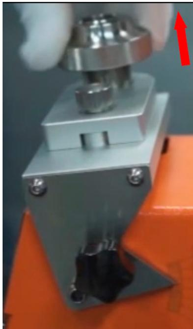
Рис. 8.5. Откручивание блока позиционирования.
