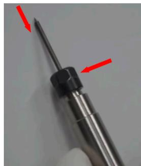
Рис. 8.3. Установка электрода.
