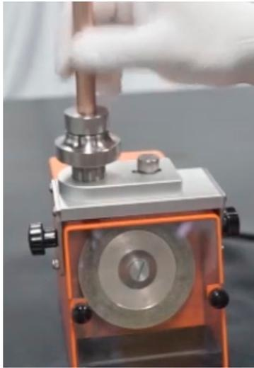
Рис. 8.6. Установка держателя электрода.
