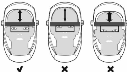
Рис. 8.5. Вертикальная регулировка.
