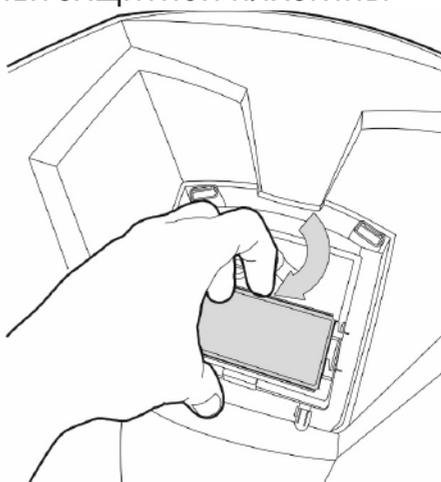
Рис. 9.2. Замена внутренней защитной пластины.
