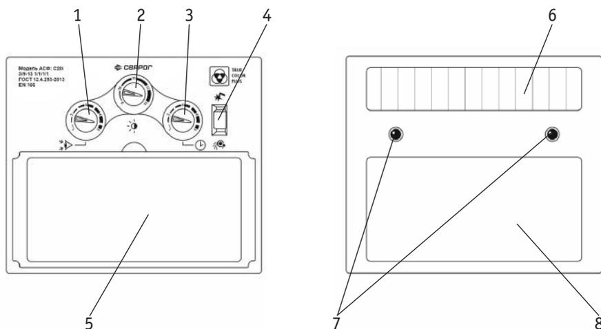
Рис. 7.3. Светофильтр модели C20i
