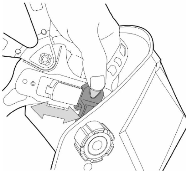
Рис. 8.7. Регулировка «ближе/дальше».
