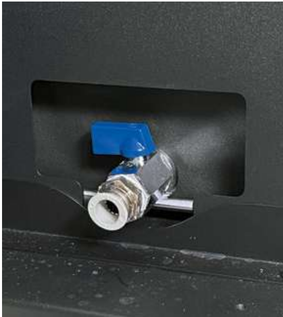
Фото 9.0.4. Слив охлаждающей жидкости.
