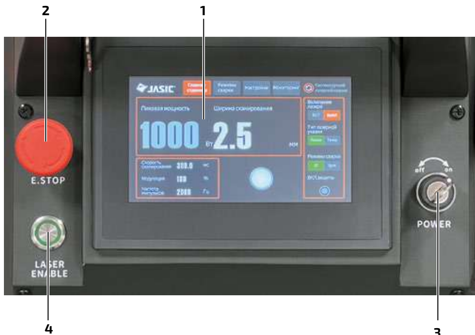
Фото 7.0.1. Панель управления источником.
