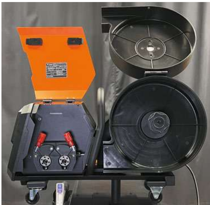
Фото 9.0.5. Установка катушки 20 кг.
