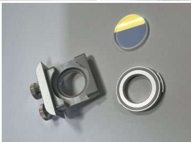
Фото 8.2.1. Замена защитного стекла.
