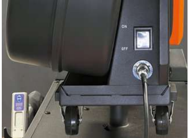
Фото 9.0.6. Подключение кабеля питания и связи.
