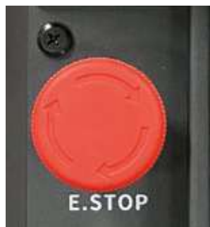
Фото 11.1.1. Кнопка аварийной остановки.
