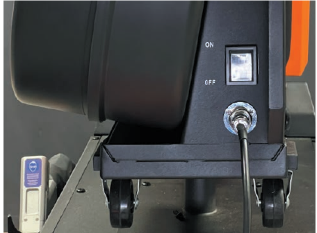
Фото 9.0.6. Подключение кабеля питания и связи.
