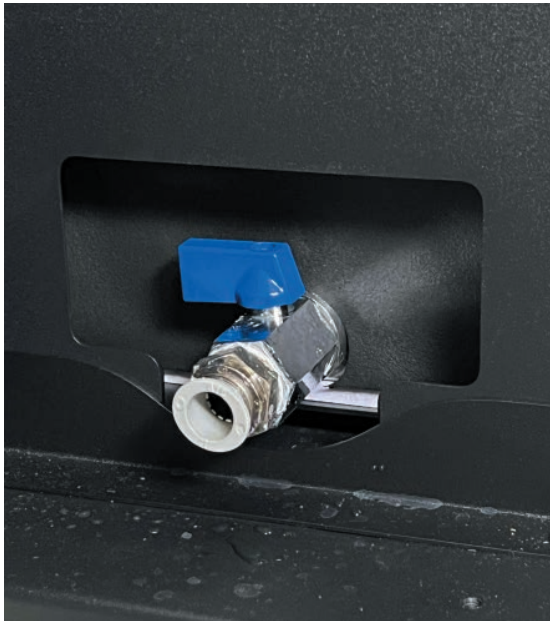
Фото 9.0.4. Слив охлаждающей жидкости.
