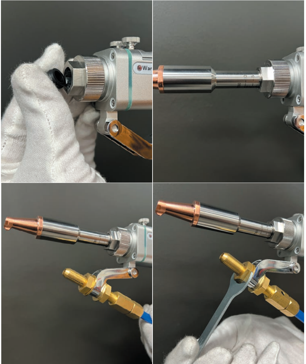
Фото 9.0.10. Сборка сварочной головки.
