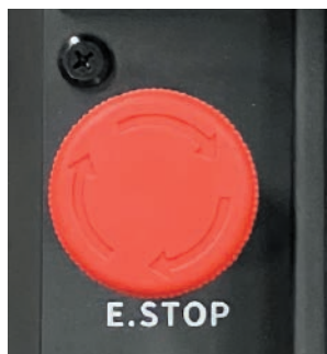
Фото 11.1.1. Кнопка аварийной остановки.
