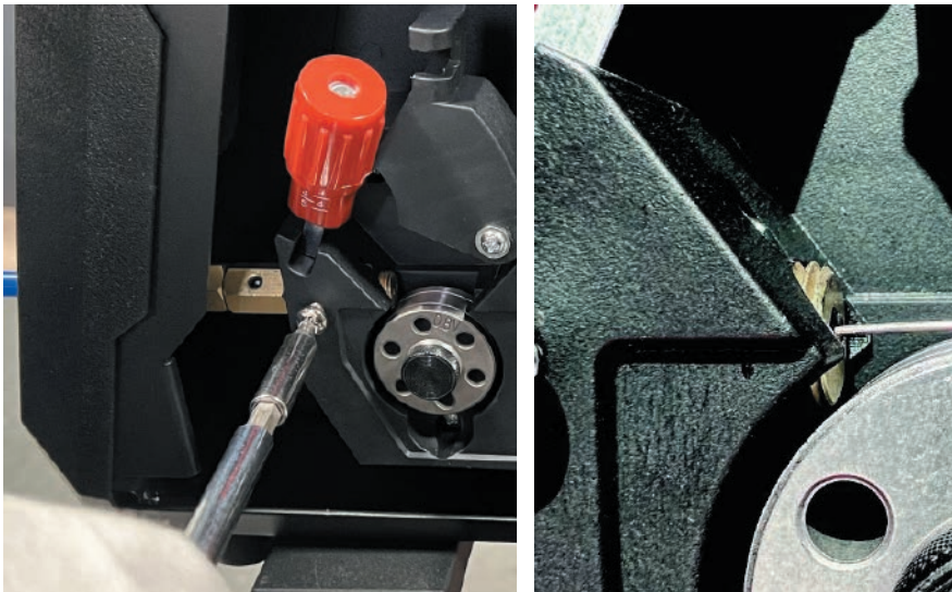
Фото 9.0.7. Установка направляющего канала.
