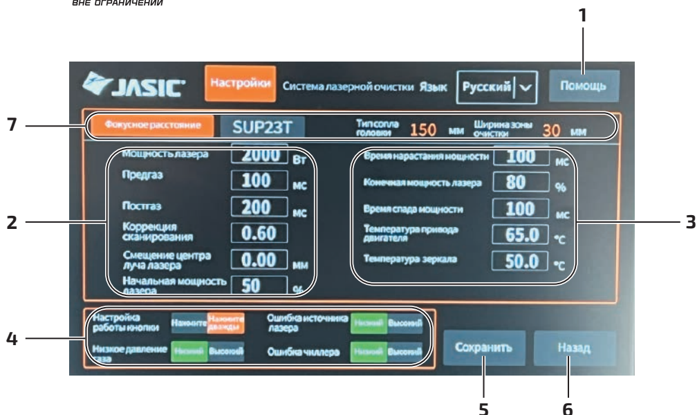
Фото 14.0.5. Главные настройки источника с фокусирующей линзой F150.
