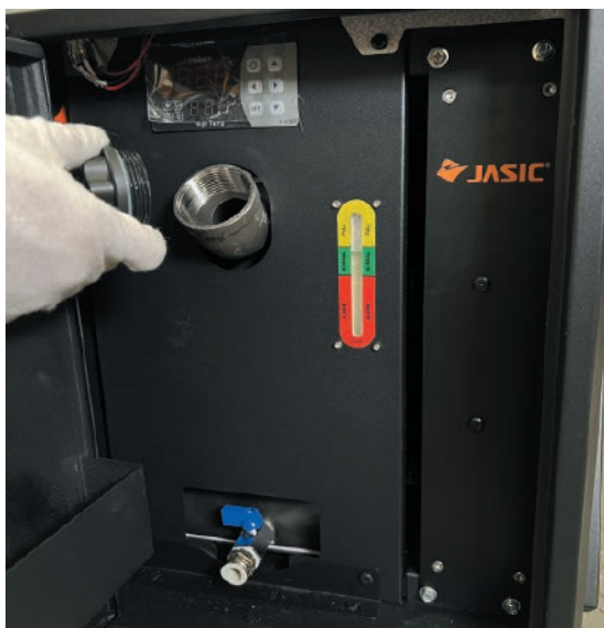
Фото 9.0.3. Заливание охлаждающей жидкости.
