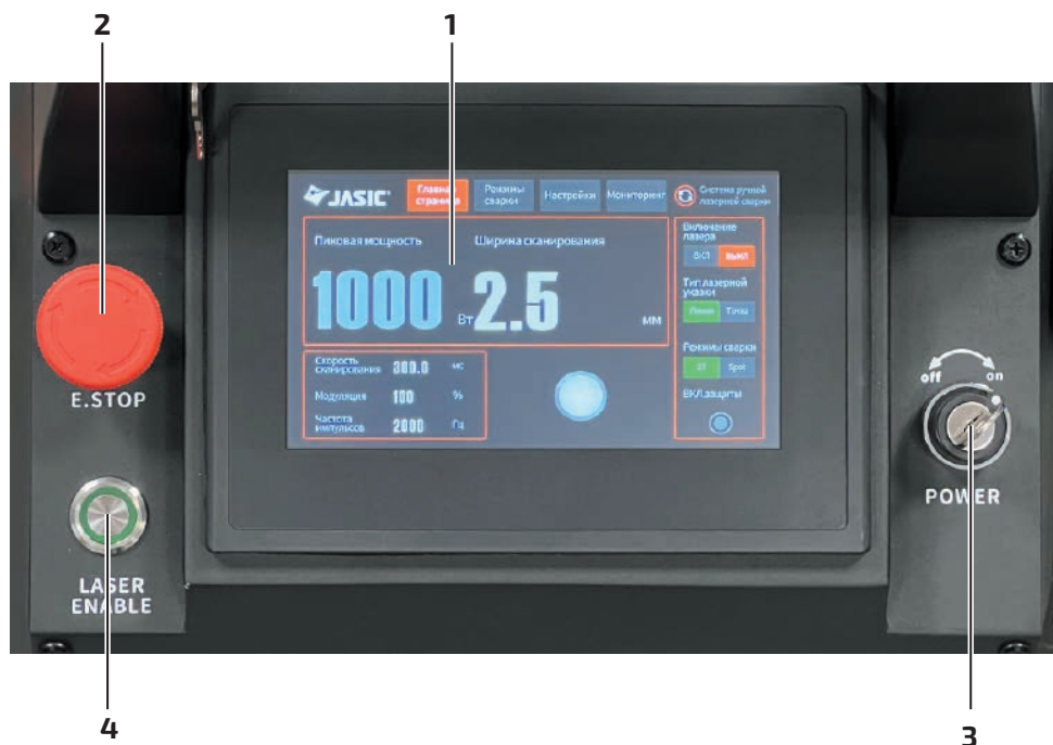
Фото 7.0.1. Панель управления источником.
