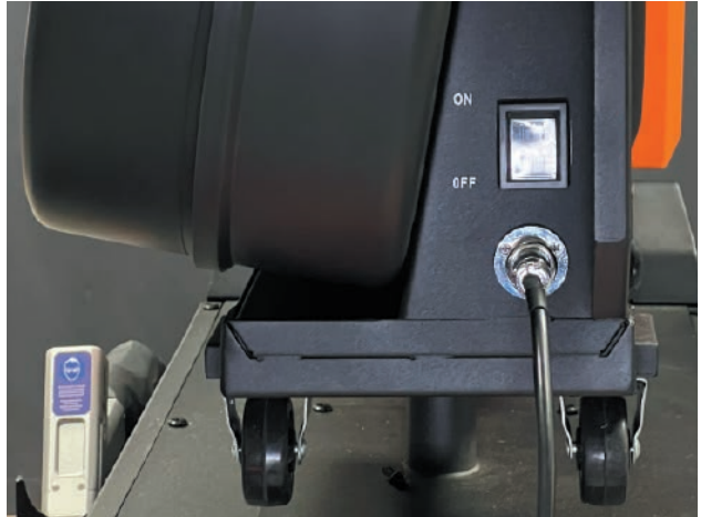
Фото 9.0.6. Подключение кабеля питания и связи.
