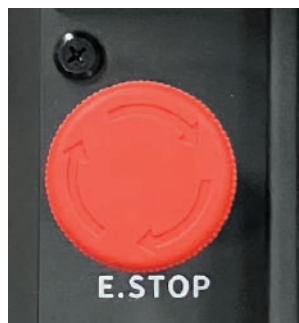
Фото 11.1.1. Кнопка аварийной остановки.
