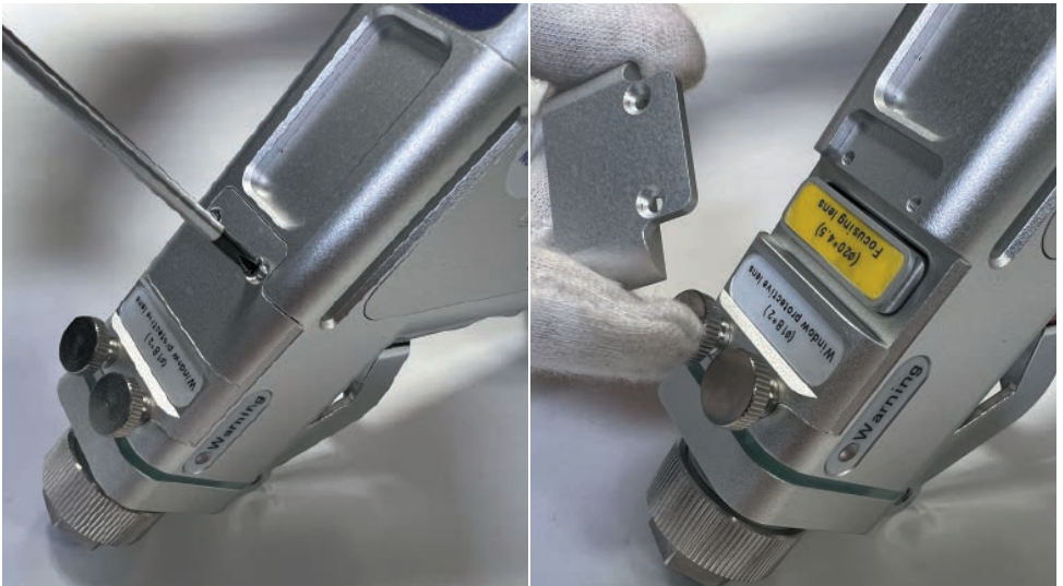
Фото 15.0.2. Снятие крышки фокусирующей линзы.
