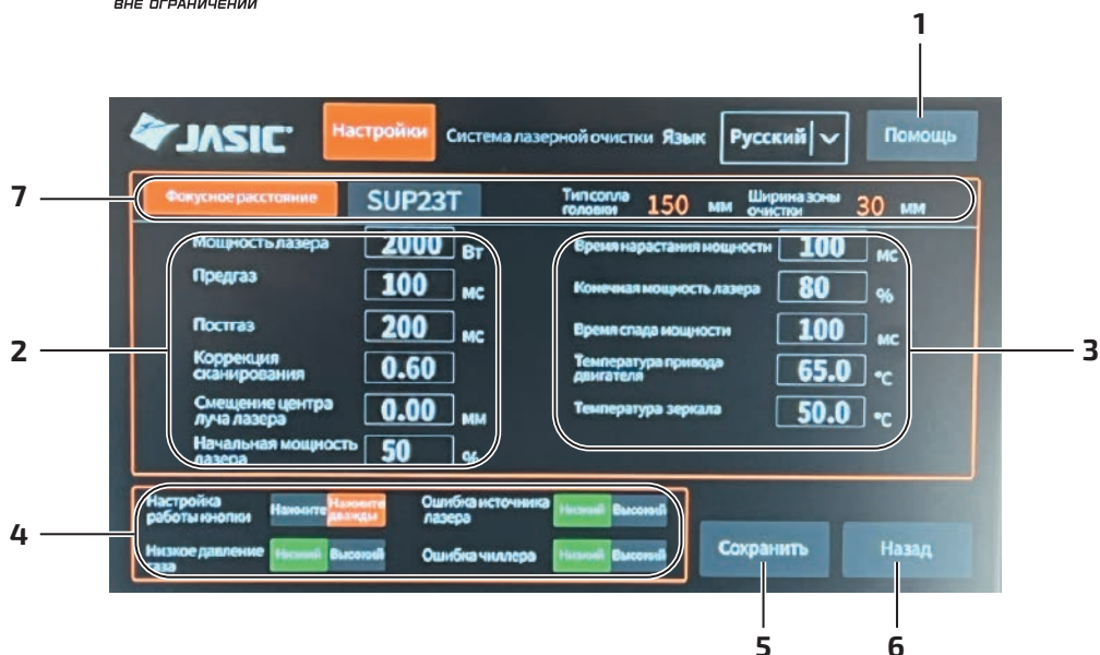
Фото 14.0.5. Главные настройки источника с фокусирующей линзой F150.
