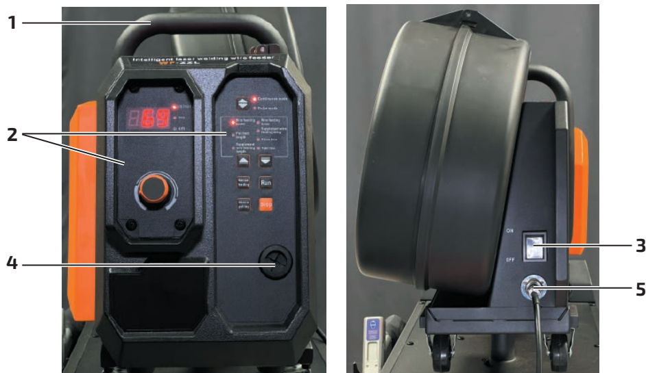
Фото 6.1.1. Внешний вид подающего механизма.
