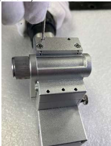
Фото 8.2.1. Снятие крышки фокусирующей линзы.
