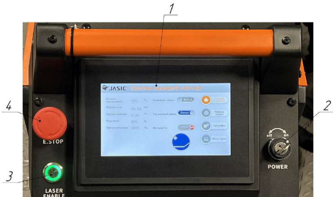
Фото 7.0.1. Панель управления источником.
