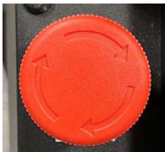
Фото 11.1.1. Кнопка аварийной остановки
