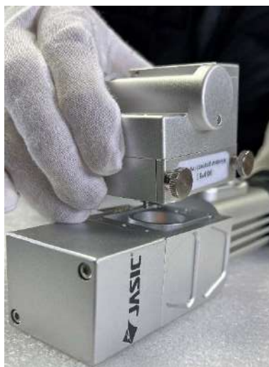
Фото 8.2.1. Снятие крышки фокусирующей линзы.
