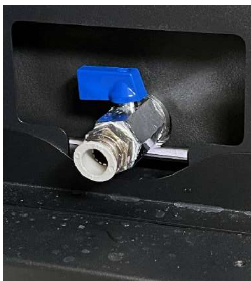
Фото 9.0.4. Слив охлаждающей жидкости
