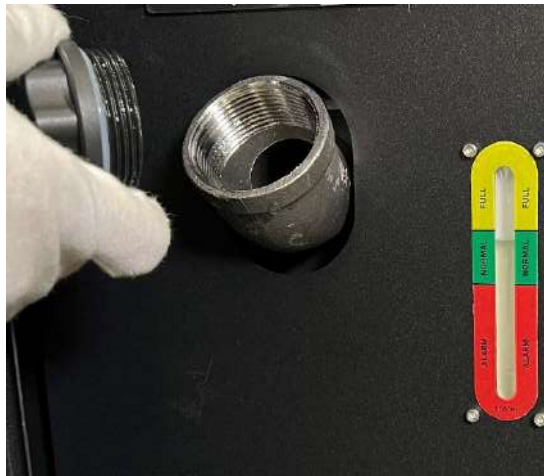
Фото 9.0.3. Заливание охлаждающей жидкости.
